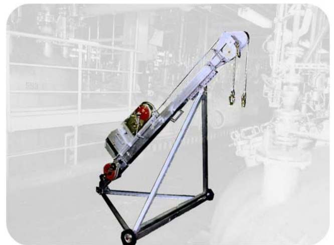
Im Einsatz: Windeneinheit mit teleskopierbaren und verstellbaren Auslegerarm
