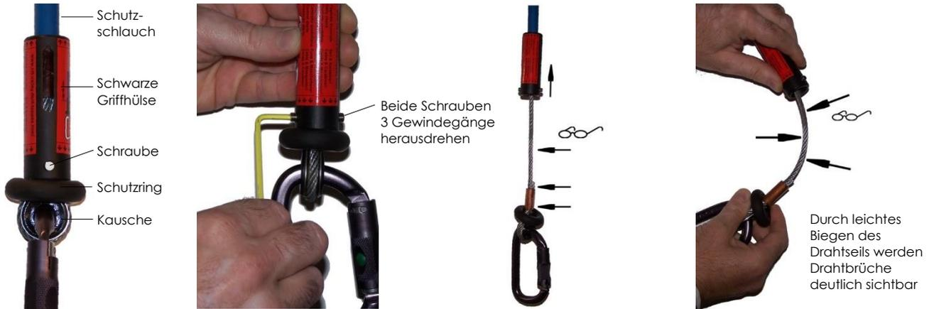
Lösen der zwei Schrauben bis 3 Gewindegänge herausstehen.
