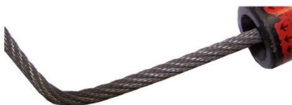
Deformación permanente del cable
