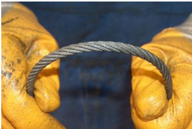
Cable en buen estado
