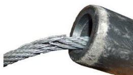
Fractura del cable en la manga del apretón
